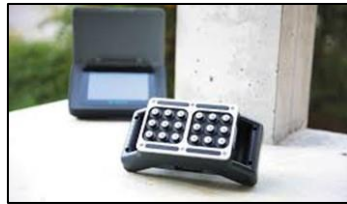
Abb. 2: Echo-Messkopf (Sender und Empfänger in einem Gerät) [Bild Proceq]
