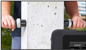
Fig. 1: Mesure de vitesse d'impulsion ultrasonique en transmission [Proceq]
