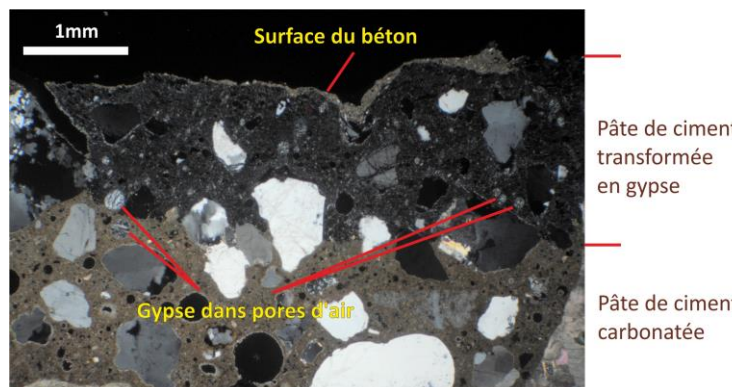
Fig. 2 : lors d'une attaque biogène par l'acide sulfurique, la pâte de ciment (carbonatée) est presque totalement transformée en gypse. La durée de service du béton est déterminée par la vitesse de pénétration du front d'attaque.
