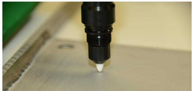
Abb. 2: Aufgesetzte EC-Pen Messspitze
