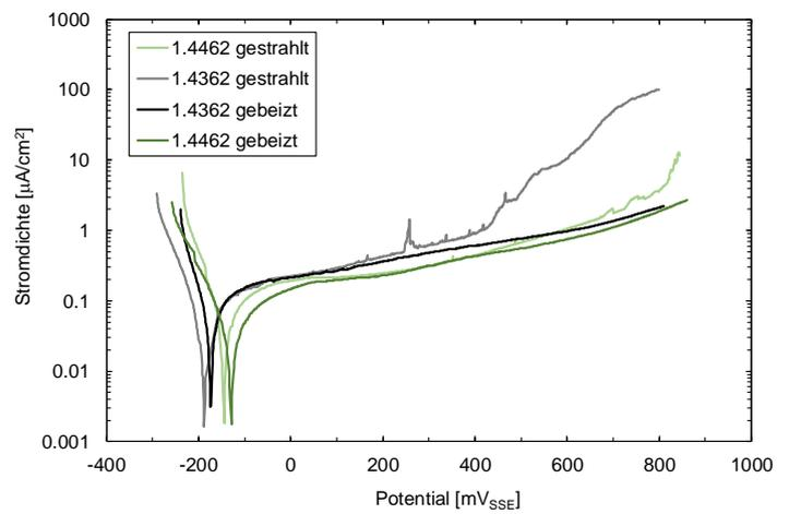
Abb. 4: Stromdichte-Potenzialkurven der Wärmeeinflusszone von geschweissten Kragplattenanschlüssen mit unterschiedlicher Stahlqualität und Oberflächenbehandlung
