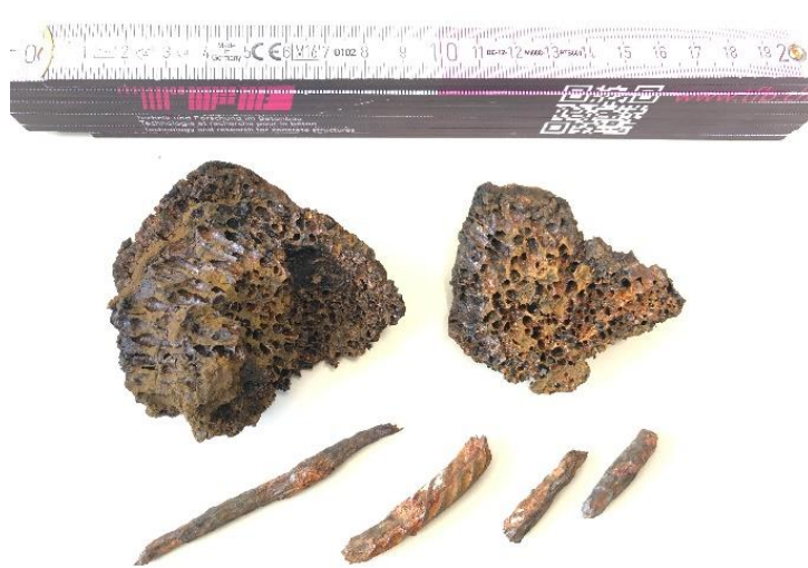
Fig.4 : Excroissances de corrosion à structure cellulaire et barres d'armature fortement corrodées provenant du sondage, comme indiqué à la Fig.2
