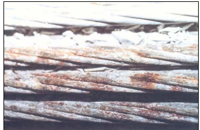
Bild 2.27 a) Intakter und stark korrodierter Spanndraht [Vogel 2002], b) Lochfrass an Spanndrähten und ein durchgerosteter/gerissener Draht und c) oberflächliche Korrosion an Litzen (SO-07).
