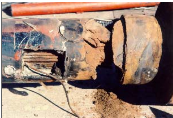
Bild 3.14 Korrosionsschäden am gerissenen Schrägseil der Brücke Zárate-Brazo Largo [Faber 2000].
