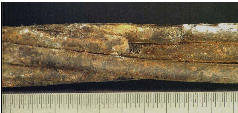
Bild 12: Detail aus Bild 11 , Ausschnitt 2 – 7 cm mit 2 Drahtbrüchen.
