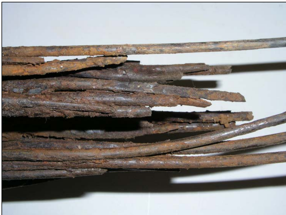
Bild 6: Detail aus Bild 5, Bruchzone, entfettete Litzen.
