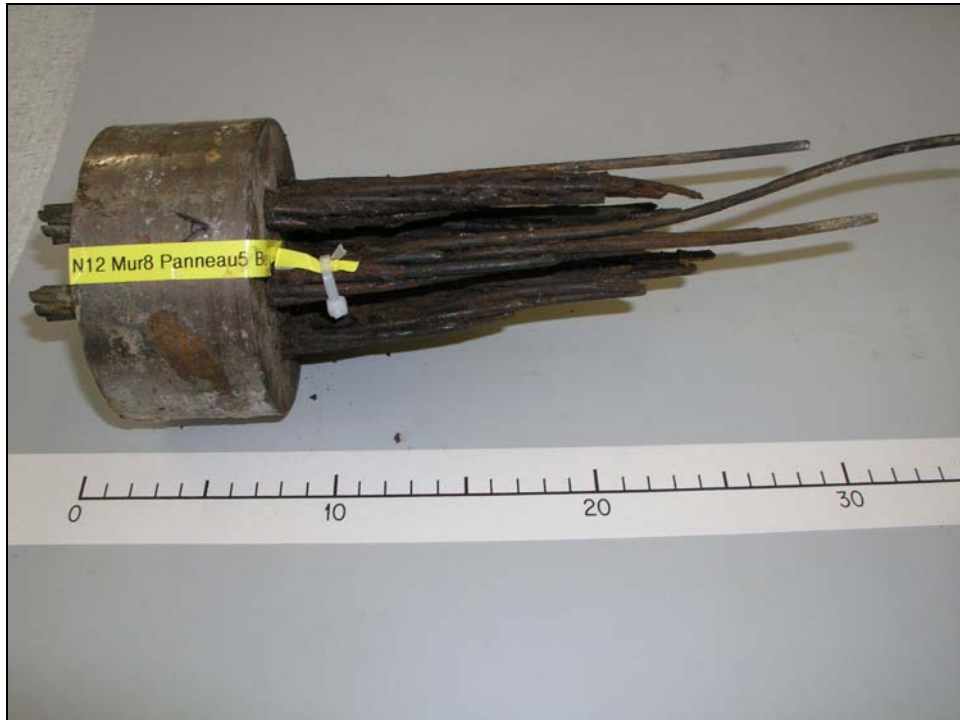
Bild 5: Spannkopf mit Litzenabschnitten eines Ankers von der Mauer Nr. 8 (Seite Bern) im Anlieferungszustand.
