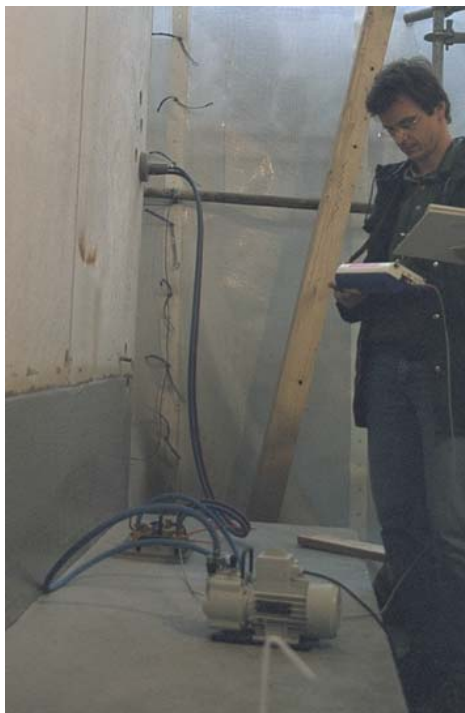
Abbildung 1: Bestimmung der Gaspermeabilität an der Versuchswand
