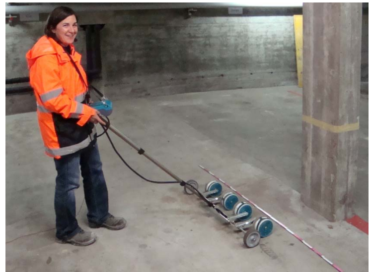
Abbildung 2: Potenzialfeldmessung mit vier Radelektroden
