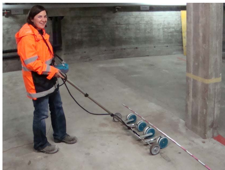
Fig. 2: mesure du champ de potentiel avec quatre électrodes à roue
