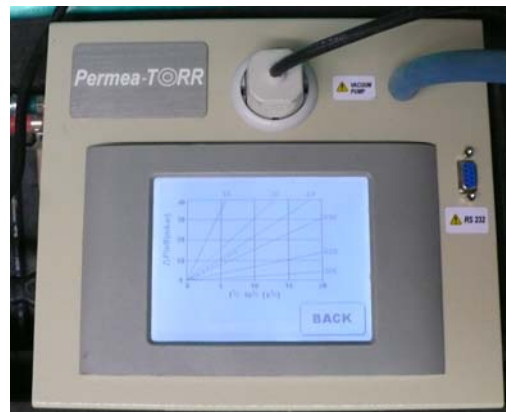
Abb. 2: Grafik mit Anzeige des Druckverlaufs während der Messung
