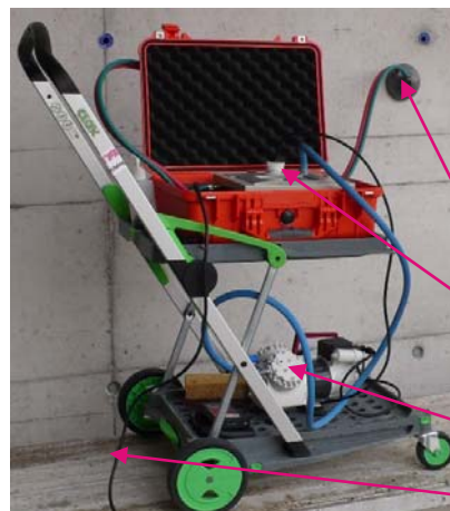
Fig. 1 : mesure de la perméabilité à l'air au moyen de l'appareil de mesure Permea TORR
